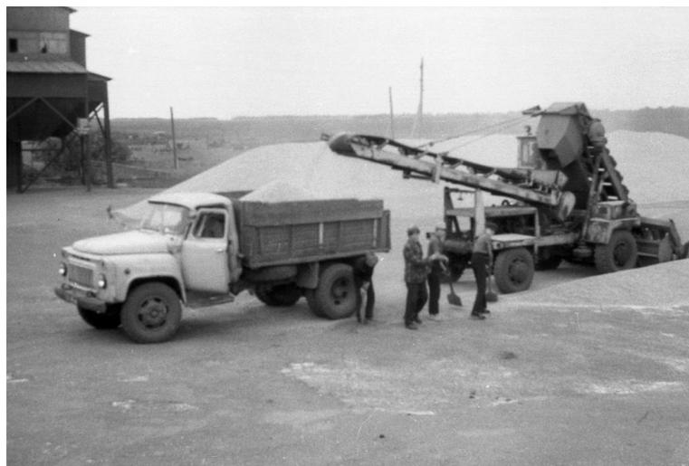
*Abb. 281: Der Traktor ist mit einem Förderband ausgestattet, über dem das Getreide auf den LKW aufgeladen und abtransportiert wird.*
