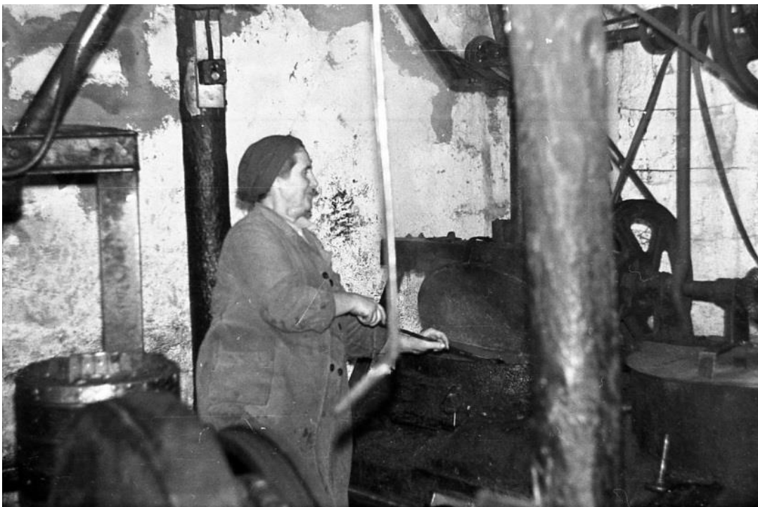
Olga Janzen (geb. Selentin) bei der Arbeit an der alten Sonnenblumen-Ölpre sse . Neben dem Pfosten links und rechts sind die beiden Pfannen, in welchen die Sonnenblumen Kerne erhitzt wurden, zu sehen.
