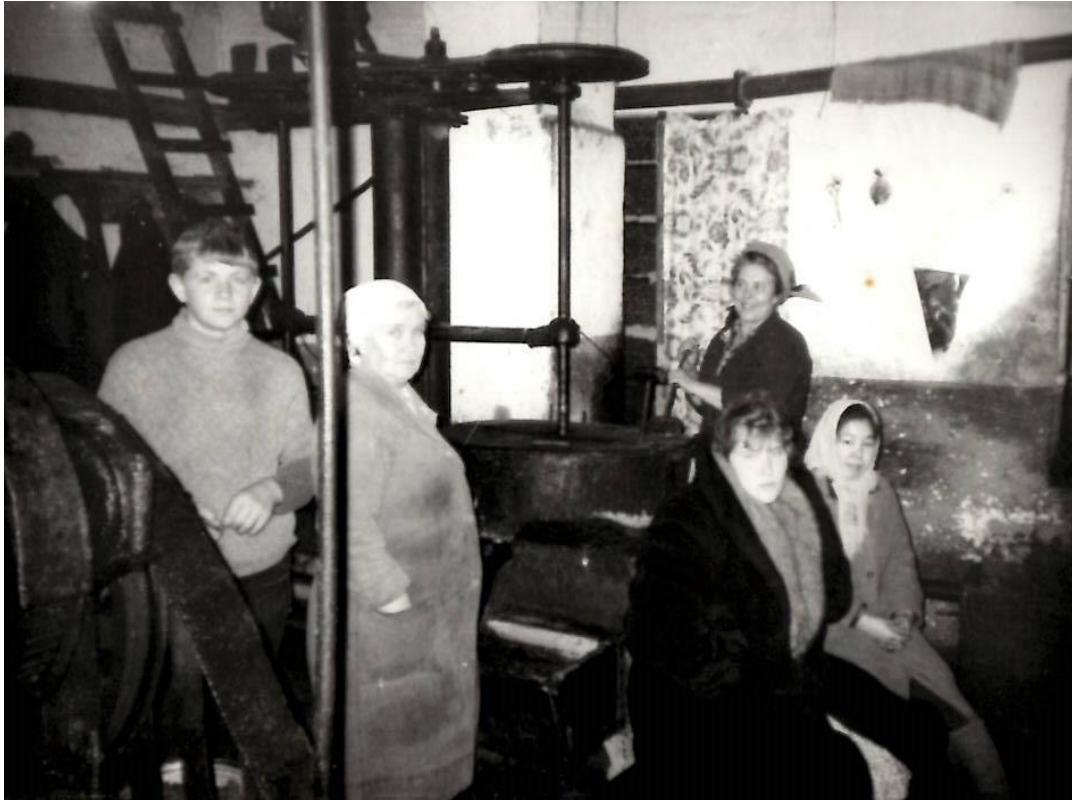
In der Mitte hinten ist die große Pfanne ist zu sehen, in welcher die Sonnenblumenkerne zerquetscht wurden, bevor sie zum Erhitzen in die zwei Pfannen kamen. Links hinten ist die Treppe zu sehen, die zum Dachboden führte.
