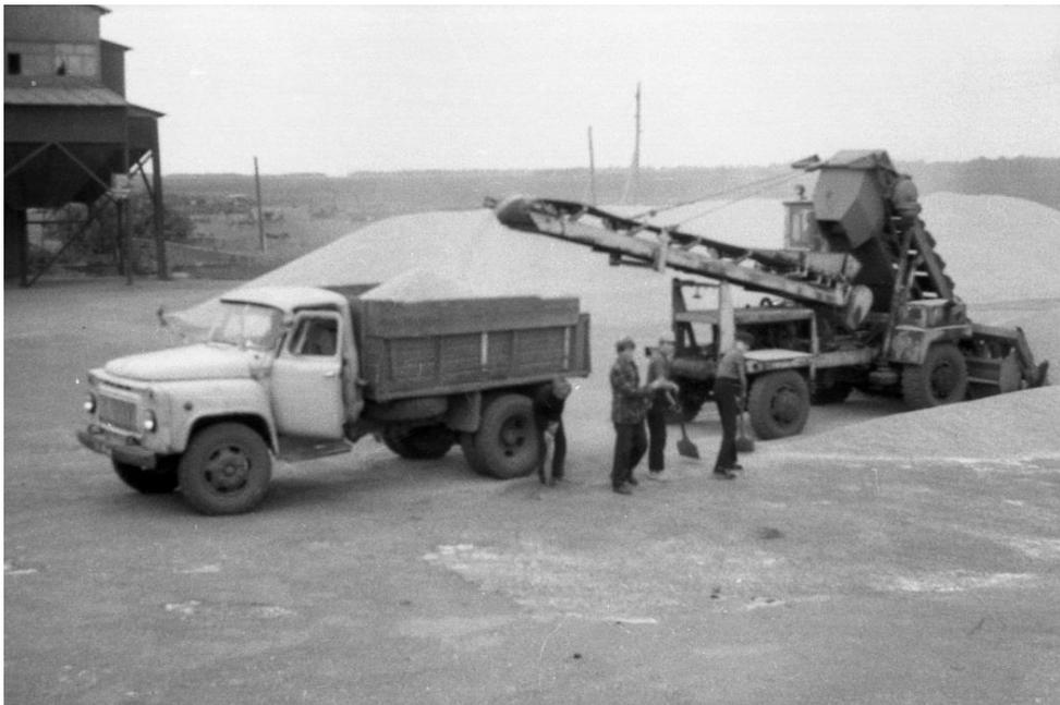
*Abb. 181: Der Traktor ist mit einem Förderband ausgestattet, über dem das Getreide auf den LKW aufgeladen und abtransportiert wird.*
