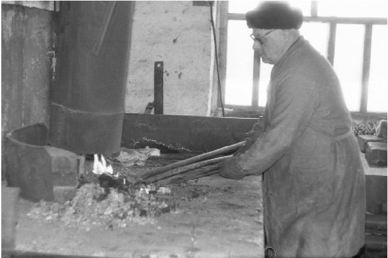
Der Schmied Johann Töws fertigt Bolzen für die Dachsparren
