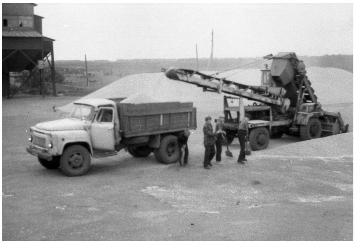
Der Traktor ist mit einem Förderband ausgestattet, darüber das Getreide auf den LKW aufgeladen und abtransportiert wird.
